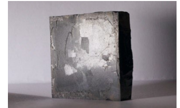
Figuur 6: Een supergeleider van een keramisch materiaal met hoge temperatuur supergeleiding is een legering van oxiden van yttrium, barium en koper in verhoudingen \text{YBa}_2\text{Cu}_3\text{O}_{7-x} , afgekort als YBCO. Bron: Wikimedia. M., Bilovitskiy
