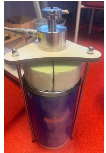
Figuur 9 cryostaat in de thermosfles met stikstof
