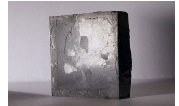
Figuur 6: Een supergeleider van een keramisch materiaal met hoge temperatuur supergeleiding is een legering van oxiden van yttrium, barium en koper in verhoudingen YBa_2Cu_3O_{7-x} , afgekort als YBCO. Bron: Wikimedia. M., Bilovitskiy
